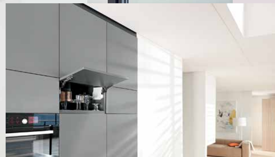
AVENTOS HK-S - max. wysokość 400 mm, max. szerokość zależy od wagi frontu i wysokości korpusu. Przeznaczony do wysokiej zabudowy, do małych szafek nad piekarnikiem, lodówką itp.
